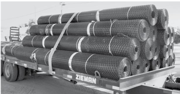
**IMAGEN 2:** Almacenamiento horizontal de los rollos de geomallas.
