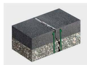
FIGURA 1: Las grietas migran hacia la superficie en una sobrecarpeta no reforzada.
