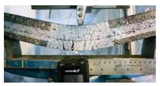
GlasGrid TF otorga una adhesión superior en la sección transversal del pavimento minimizando las grietas y maximizando el desempeño.
