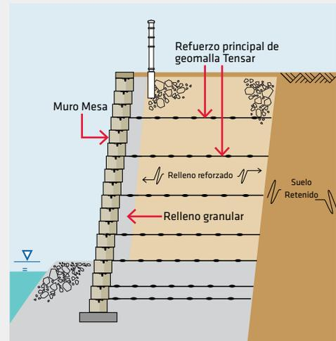
► El sistema de muros de contención SierraScape® ofrece una alternativa más accesible para concretar varios de los requisitos de cambios de nivel.
