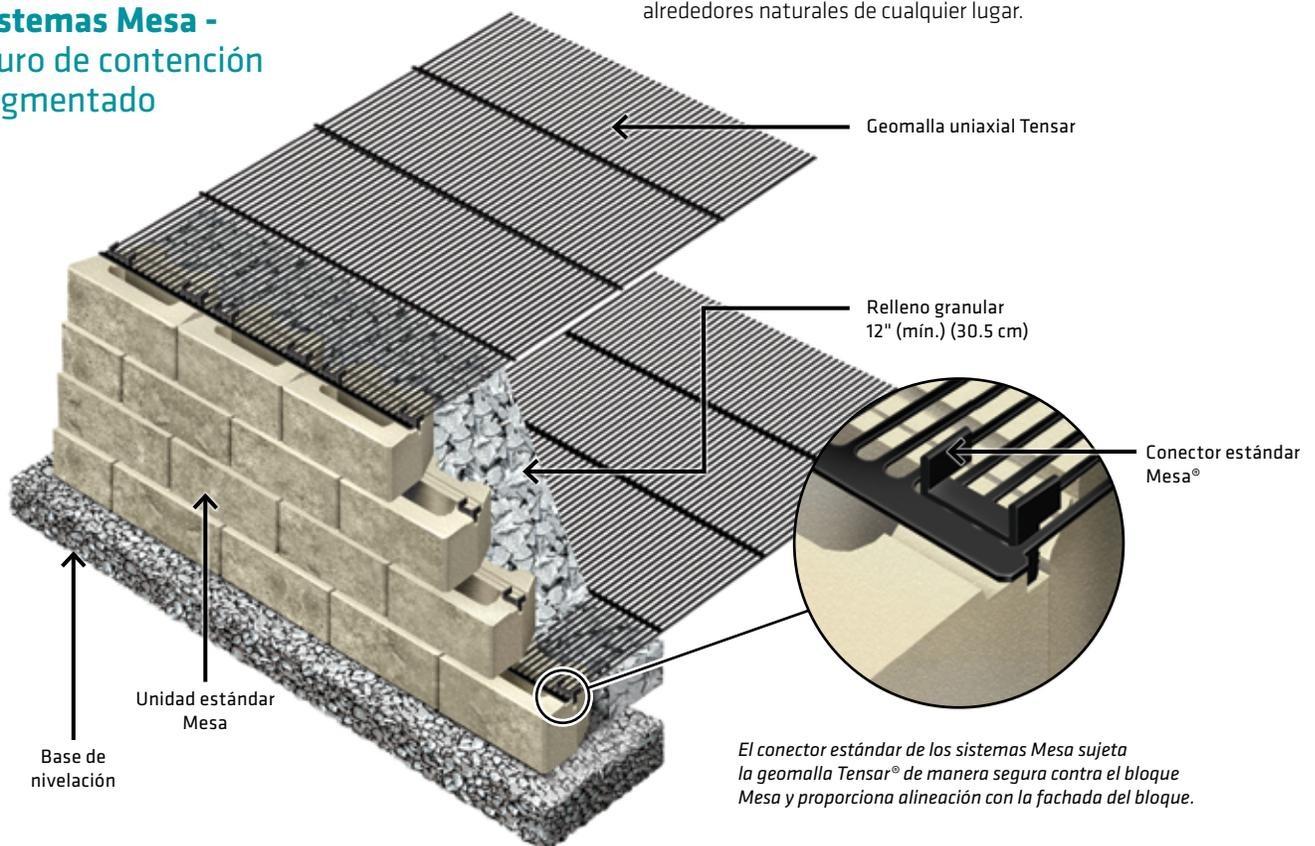
*El conector estándar de los sistemas Mesa sujeta la geomalla Tensor® de manera segura contra el bloque Mesa y proporciona alineación con la fachada del bloque.*
