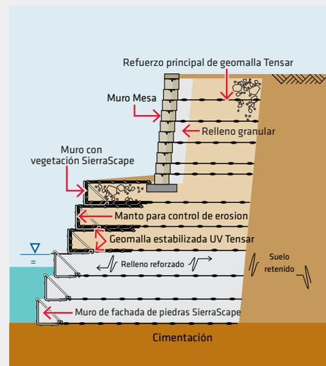
► El sistema de contención de taludes Sierra® proporciona una alternativa económica y estética para los muros de contención convencionales.
