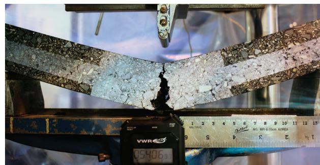
Une poutre de chaussée d'asphalte non renforcé avec couche d'accrochage conventionnelle se fissure de façon prévisible sous contrainte au bout d'une courte période.
