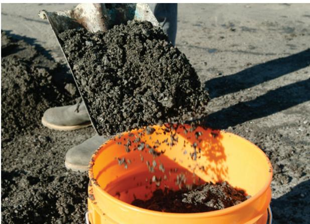
**IMAGE A :** L'asphalte broyé contenant le produit GlasGrid peut être facilement recyclé en vue d'être utilisé pour d'autres projets.
